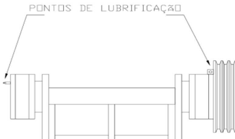
Figura 2 – Pontos de Lubrificação
